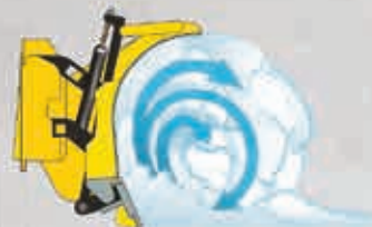
Le design de la lame permet de rouler la neige efficacement.
